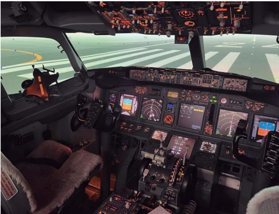
Simulador de nivel D de Boeing 737-800 fabricado por Indra y explotado por GTA.
