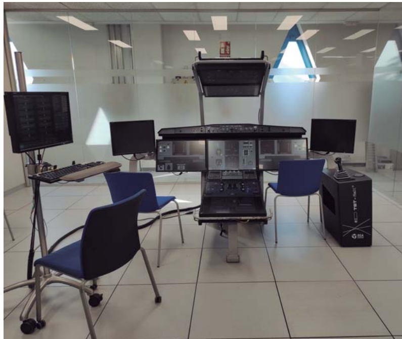
Como complemento a los simuladores de vuelo, se usan equipos intermedios que permiten optimizar las fases iniciales de instrucción.
