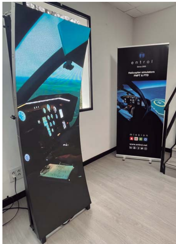
Panel modular compuesto por componentes de LED independientes de Entrol.
